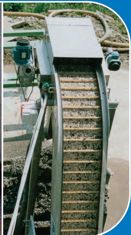
Sistema di rimozione dei materiali grossolani dalle acque da depurare mediante griglia sub verticale per installazione in canale.
