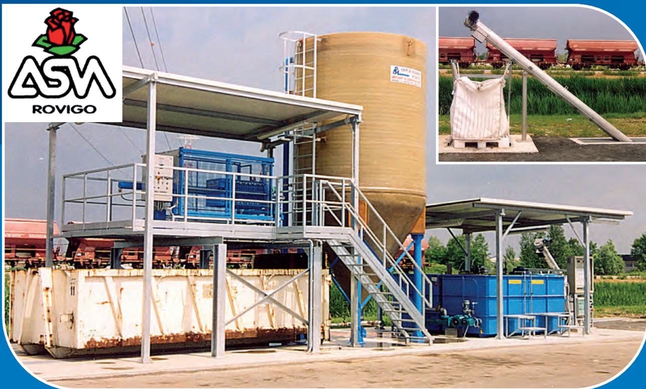
Impianto chimico-fisico completo di sezione disidratazione fanghi mediante filtropressa.
