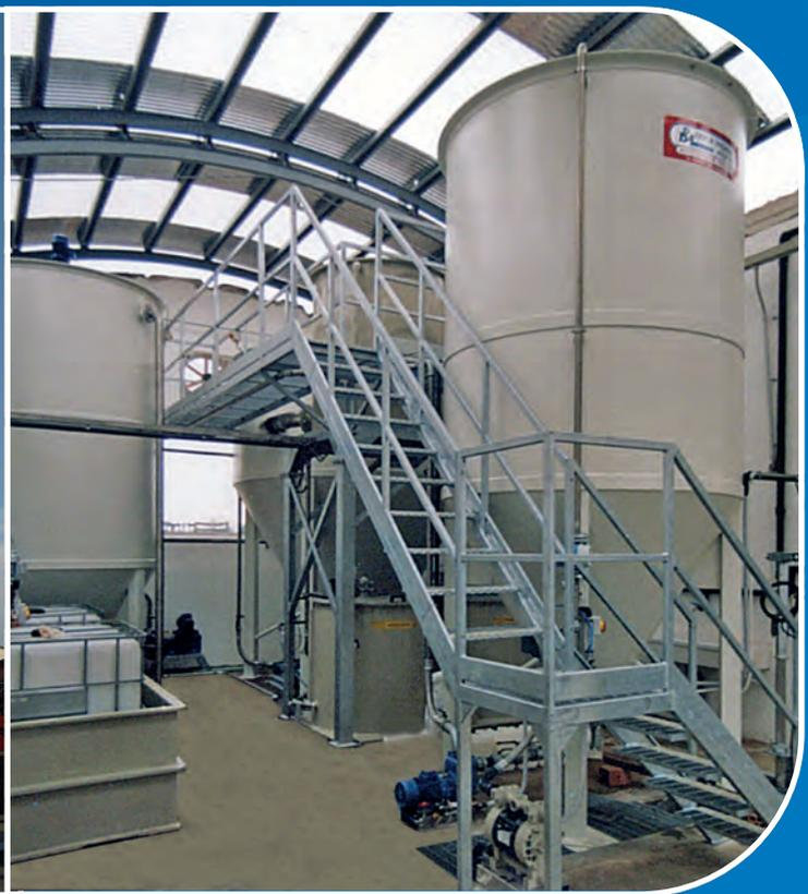
Impianto chimico-fisico attrezzato con filtropressa automatica, per la disidratazione dei fanghi di processo.
