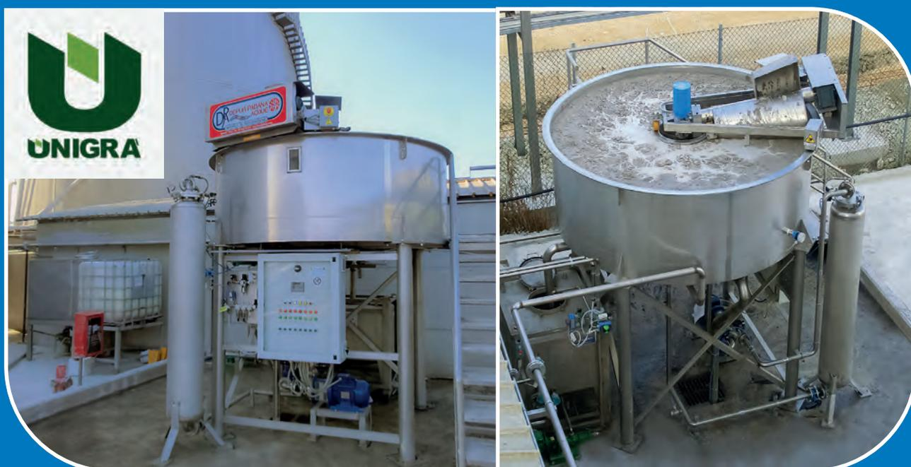
Impianto di flottazione ad aria disciolta pressurizzata, della potenzialità idraulica di 44 m<sup>3</sup>/h.
