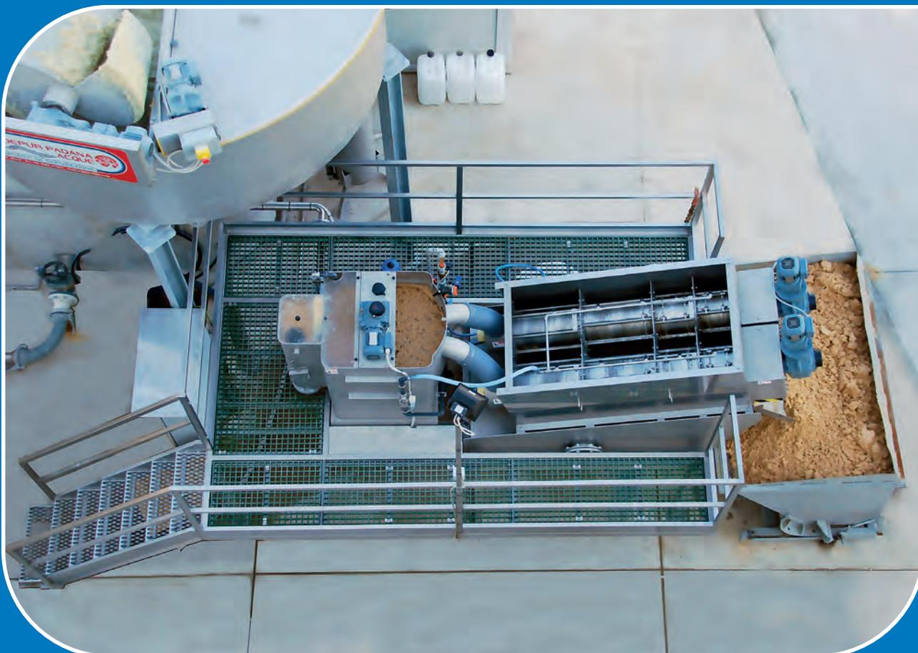
**SEZIONE DI DISIDRATAZIONE DEL FLOTTATO MEDIANTE PRESSOCOLEA**
