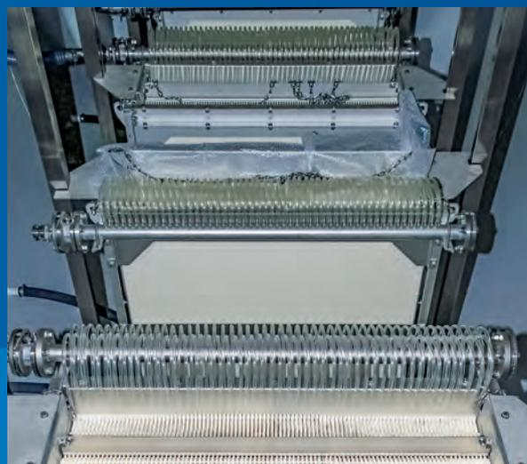
**Moduli membrane piane di ultrafiltrazione
