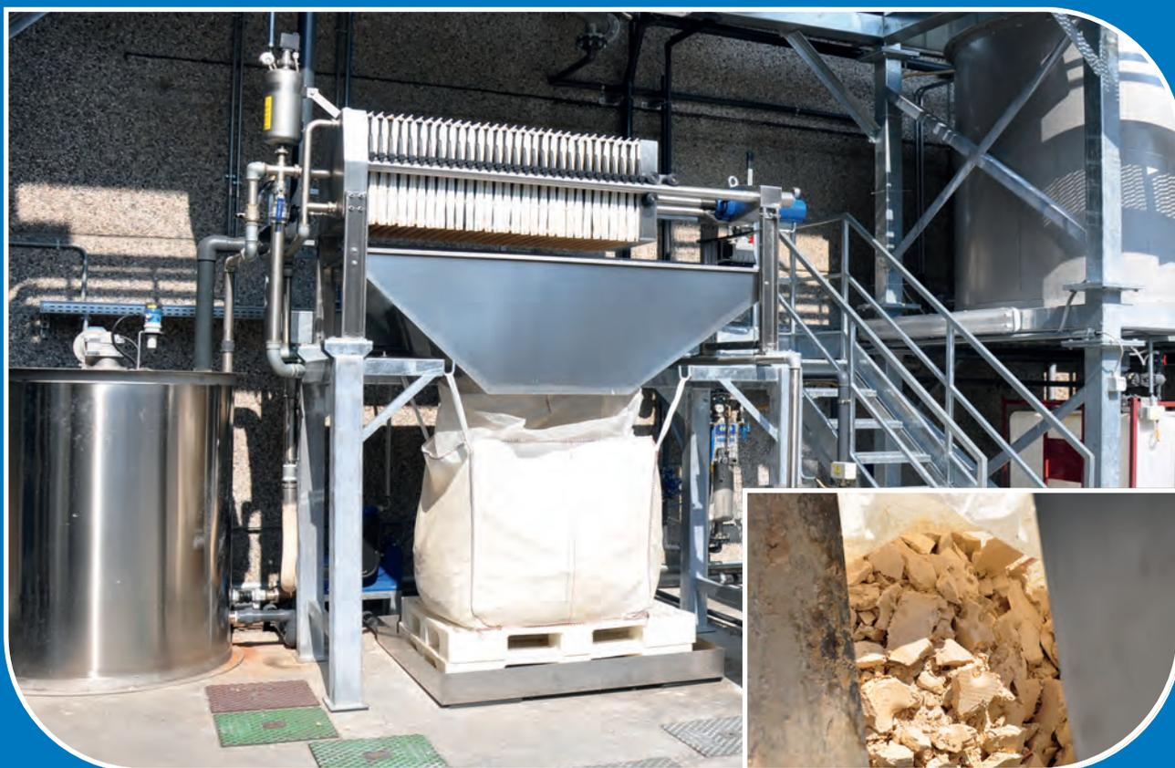
UNITÀ DI FILTRAZIONE MEDIANTE FILTROPRESSA INTERAMENTE IN ACCIAIO INOX
